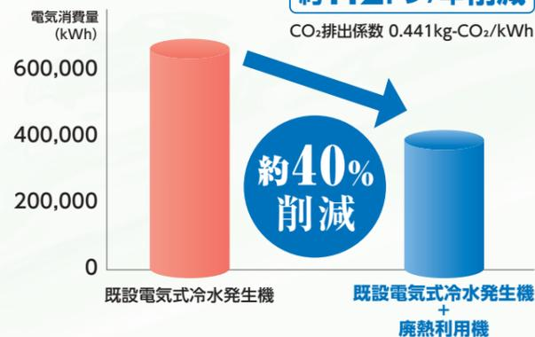
※ 左記グラフは、廃熱利用機増設時における既設電気式冷水発生機の稼働率削減効果を表しています。
